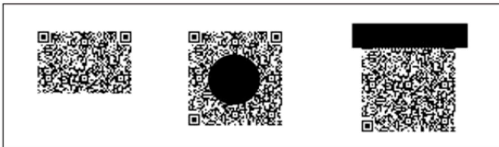
Слика 8, Пример оштећеног и упрљаног кода
