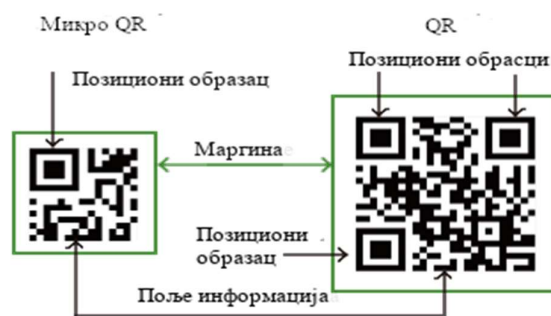
Слика 11, Упоредни приказ позиције и броја позиционих образаца код Micro QR и QR кодова
